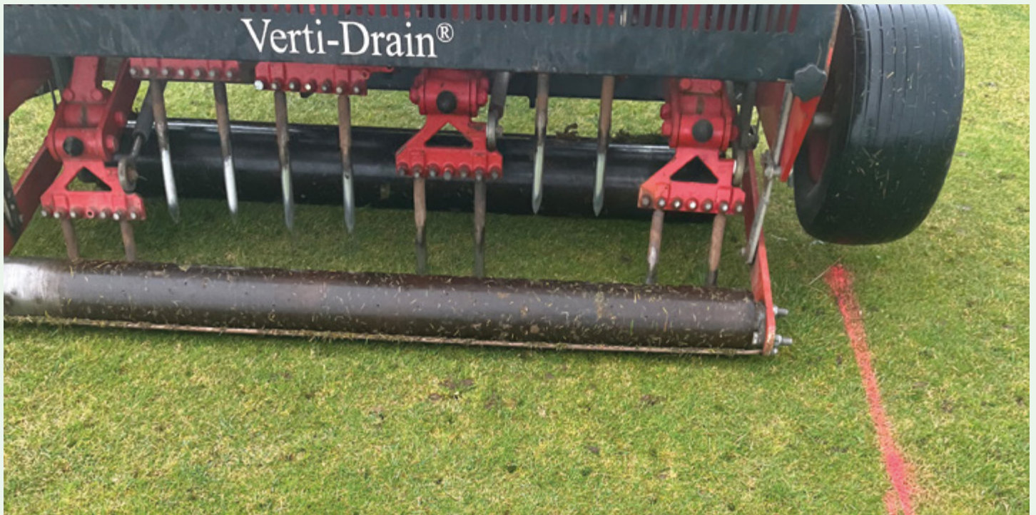
Bilde 3. Djuplufting med Vertidrain på Kalundborg GK 28.oktober 2024.
